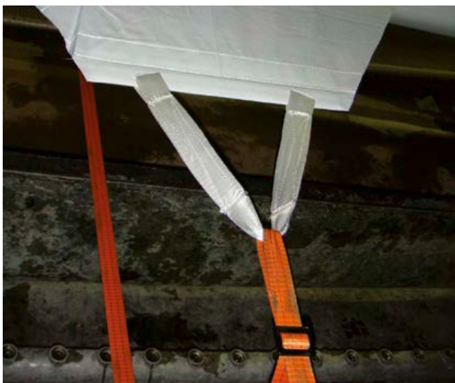
Foto 3: Nur eine Gurtschnalle im Einsatz (nach oben gewölbt).
