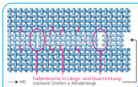
Abb.9 Fadenbrüche durch trockene Streifen
