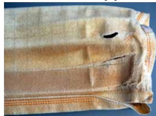
Abbildung 2: Sekundär mechanisch beschädigter Filterschlauch nach chemischer Vorschädigung
