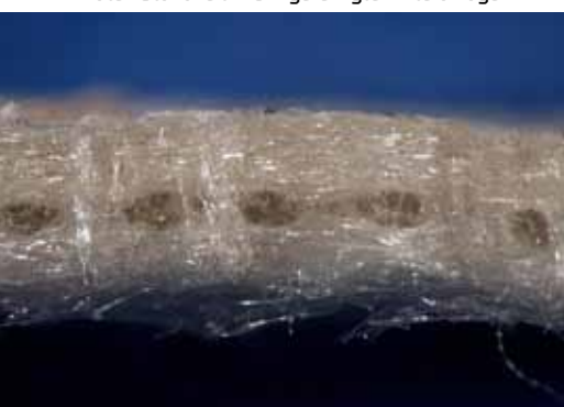
Abbildung 4: Querschnitt durch ein intaktes Filtermedium nach zwölf Monaten Standzeit
