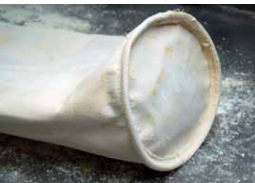
Abbildung 3: Filterschlauch aus PPS nach zwölf Monaten Standzeit in CIP-gereinigter Filteranlage
