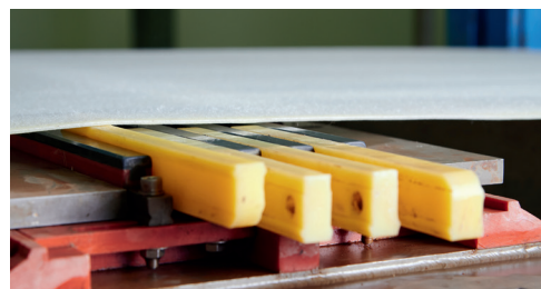
Abb. 15: Erhabener Randbegrenzer am Rohrsauger
