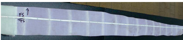
Abb. 12: Zonaler Filzverschleiß optisch im gelaufenen Filz erkennbar
