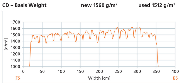
Abb. 13: Zonaler Filzverschleiß im Flächengewicht des gelaufenen Filzes erkennbar
