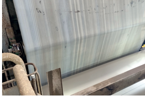
Abb. 10: Hieraus resultierend: Feuchtestreifen im Filz
