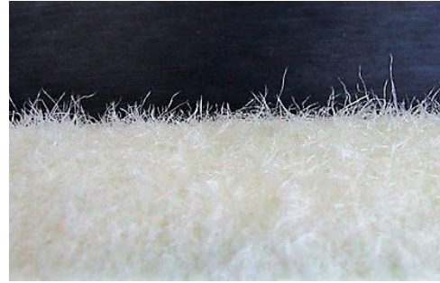
Abb. 7: Faserbeanspruchung bei 30 bar deutlich höher
