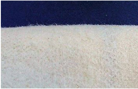
Abb. 6: Filzoberfläche bei 15 bar Dauerbetrieb
