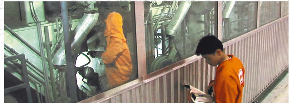
Abb. 5: Temperaturmessung in der Trockenhaube
