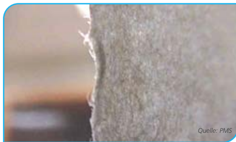
Abb.1 Fehler an den Bahnkanten
