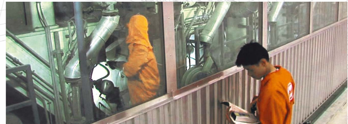
Fig. 5 : Mesures de température dans la hotte de sécherie
